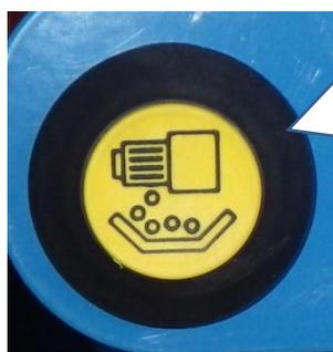
Appuyer sur ce bouton pour remplir le sac de graines (maintenir le bouton enfoncé jusqu'à ce que le sac contienne une quantité de graines pouvant être pesée)
