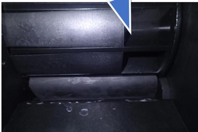
Une fois que vous aurez vidé le réservoir, nous vous recommander de « semer » encore quelques mètres avec une semeuse à vide dont le ventilateur tourne, ceci pour évacuer les résidus de graines qui pourraient encore se trouver dans les doseurs et dans le système de la semeuse.
